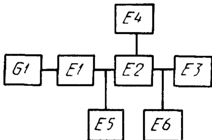
*G1*—генератор СВЧ мощности; *E1*—вентиль ферритовый; *E2*—линия измерительная; *E3*—камера диодная; *E4*—усилитель измерительный; *E5*—частотомер; *E6*—измеритель мощности
