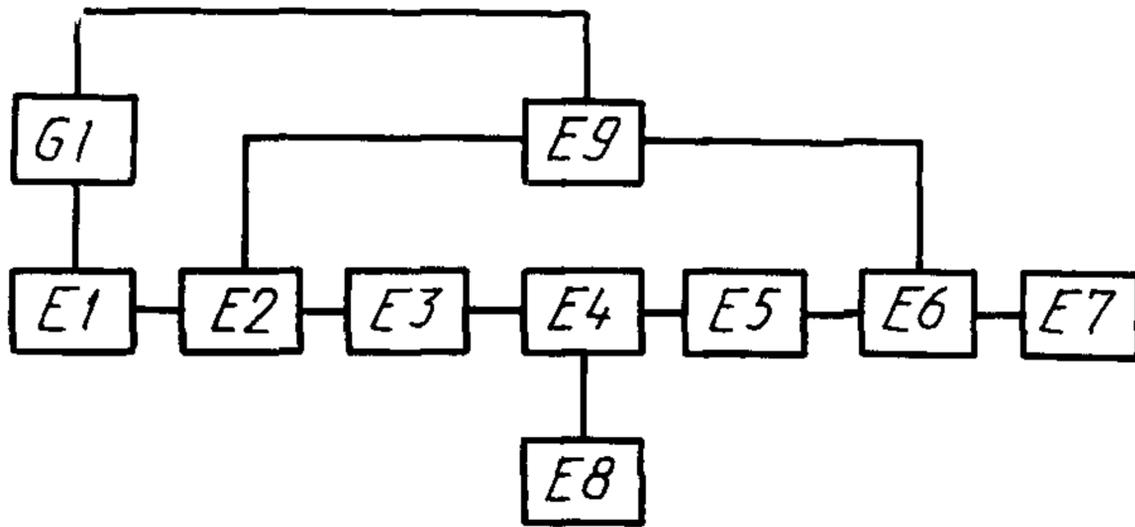
*G1*—генератор качающейся частоты; *E1*—аттенюатор;
