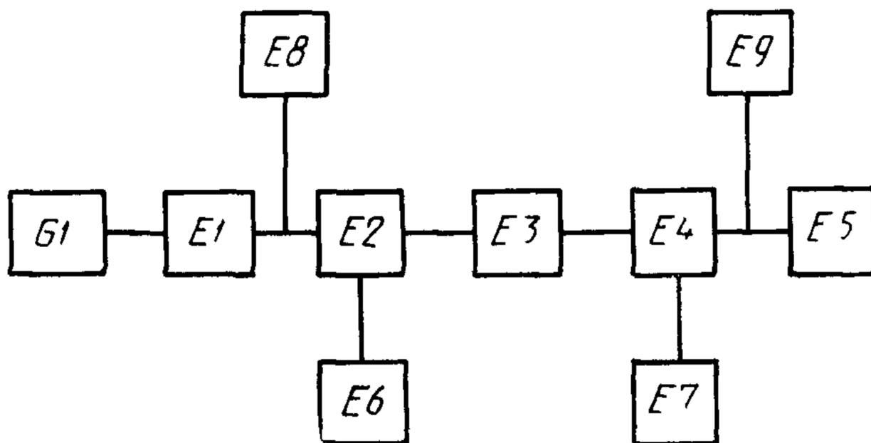
$G1$ —генератор СВЧ мощности  $E1$ ,  $E3$ —вентили  $E2$ —тройник ввода смещения;  $E4$ —линия измерительная,  $E5$ —камера диодная,  $E6$ —источник смещения,  $E7$ —измерительный усилитель,  $E8$ —частотомер,  $E9$ —измеритель мощности
