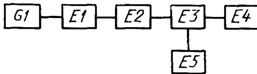
*G1*—генератор СВЧ мощности; *E1*—вентиль ферритовый; *E2*—аттенюатор; *E3*—линия измерительная; *E4*—нагрузка согласованная; *E5*—индикаторный прибор
