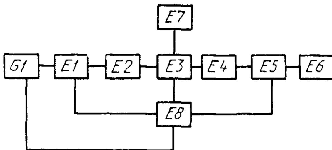
$G1$ —генератор качающейся частоты,  $E1$ —ответвитель направленный;  $E2$ ,  $E4$ —вентили ферритовые;  $E3$ —тройник ввода смещения;  $E6$ —камера диодная;  $E7$ —источник смещения;  $E8$ —индикатор КСВН и ослаблений;  $E5$ —линия измерительная
