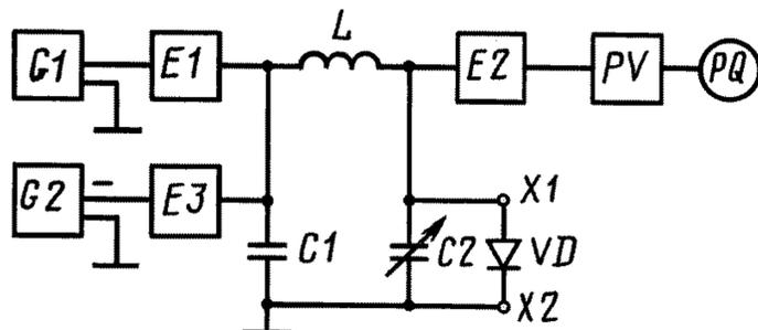
$G1$  — генератор высокой частоты;  $G2$  — источник напряжения смещения;  $E1, E2$  — элементы связи;  $E3$  — элемент развязки;  $C1$  — конденсатор;  $L$  — индуктивность контура;  $C2$  — емкость контура;  $PV$  — селективный усилитель;  $PQ$  — измерительный прибор;  $VD$  — измеряемый варикап;  $X1, X2$  — контакты подключения варикапа, воздушного конденсатора или меры емкостной добротности
