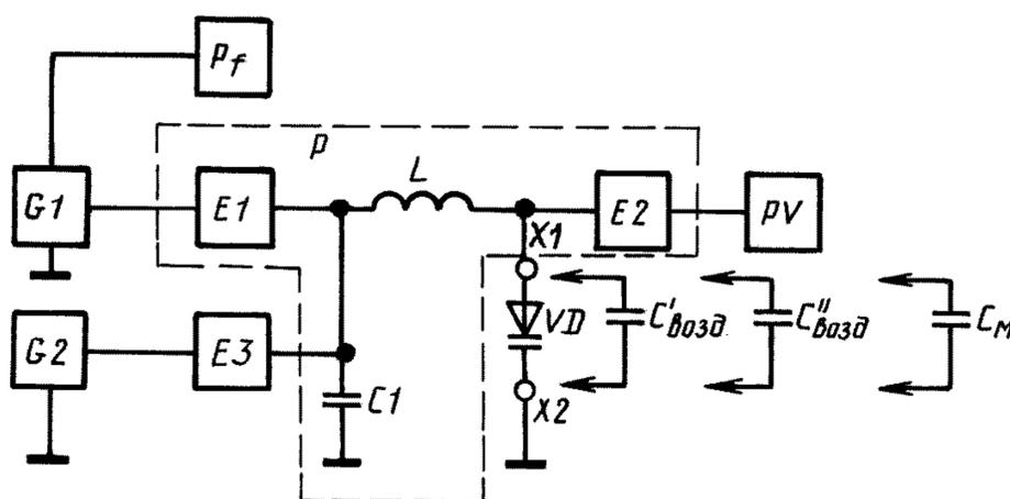
$G_1$  — генератор с перестраиваемой частотой;  $E_1, E_2$  — элементы связи по высокой частоте;  $Pf$  — частотомер;  $G_2$  — источник постоянного напряжения;  $L$  — индуктивность контура;  $X_1, X_2$  — контакты для подключения варикапа  $VD$ , воздушных конденсаторов  $C'_{\text{возд}}$ ,  $C''_{\text{возд}}$  или меры емкостной добротности  $C_M$ ;  $PV$  — высокочастотный вольтметр;  $P$  — резонатор
