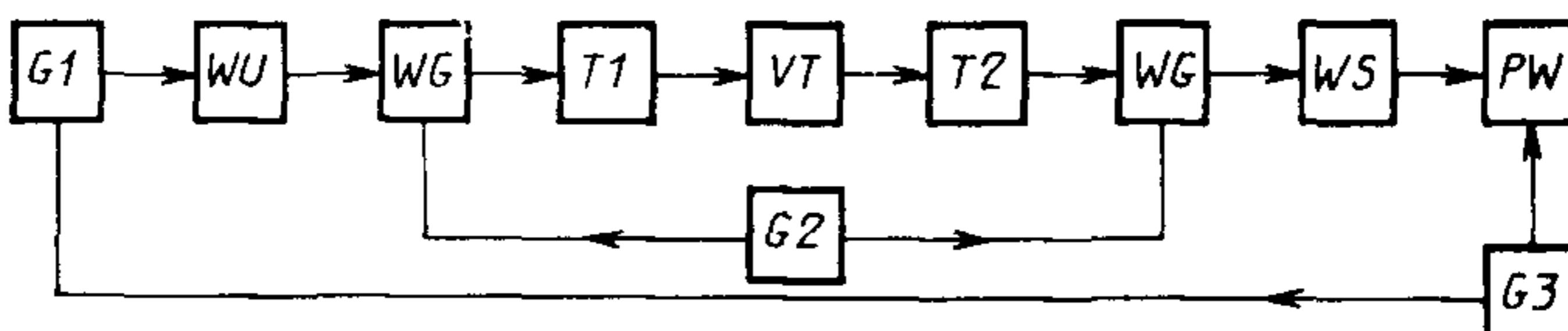
$G_1$  — источник сигнала;  $WU$  — развязка;  $WG$  — ввод питания при подаче питания через контактное устройство может отсутствовать;  $T_1$  и  $T_2$  — входной и выходной трансформаторы полных сопротивлений;  $VT$  — измеряемый транзистор с контактным устройством;  $WS$  — вентиль в ряде случаев может отсутствовать;  $PW$  — измеритель шумовой мощности и индикатор;  $G_2$  — блок питания транзистора по постоянному току;  $G_3$  — блок питания и управления измерителем
