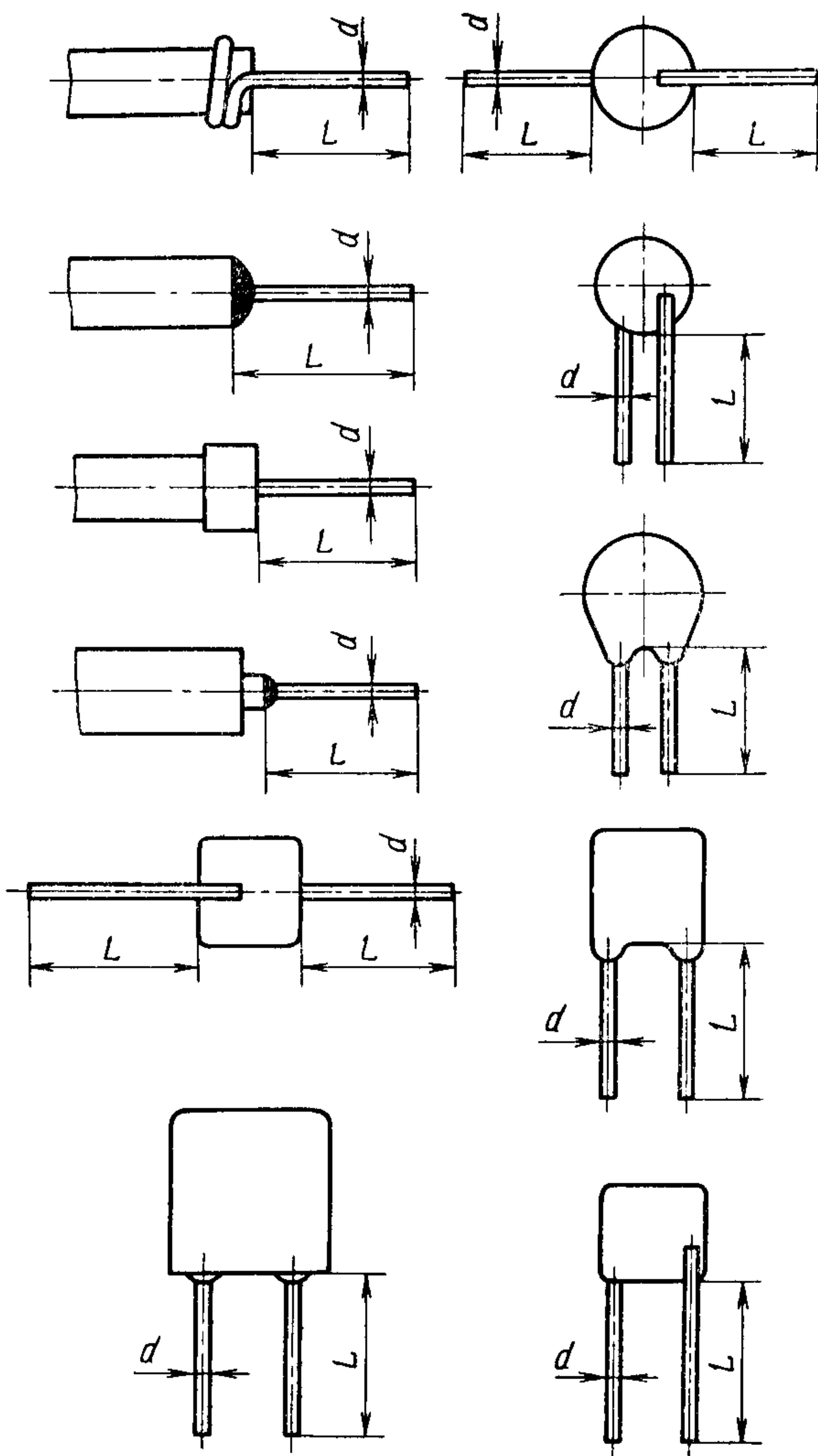
6. При необходимости изготовления мелких серий специальных электрических конденсаторов и резисторов с другими монтажными длинами и диаметрами размеры должны устанавливаться по ряду Ra10 ГОСТ 6636—60 и согласовываться между заказчиком и изготовителем.
