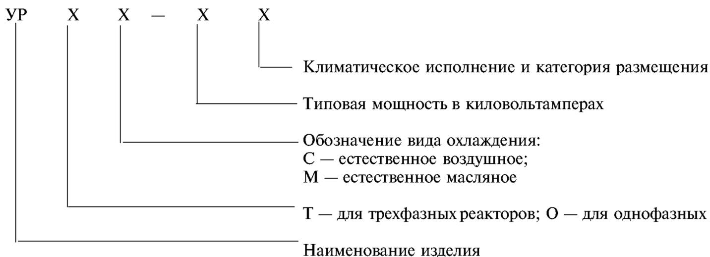
Примеры условного обозначения однофазного уравнильного реактора с естественным масляным охлаждением, мощностью 1000 кВ·А, климатического исполнения У, категории 2:
