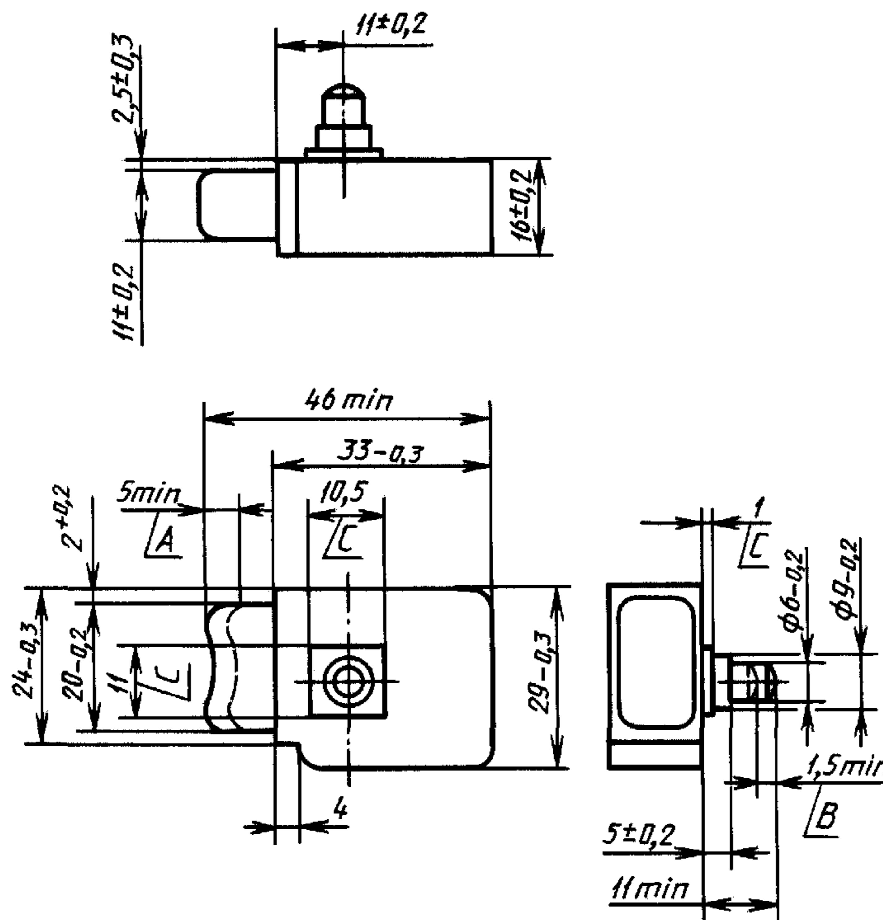
*A* — ход кнопки управления; *B* — ход кнопки фиксации; *C* — направляющая часть кнопки для фиксации
