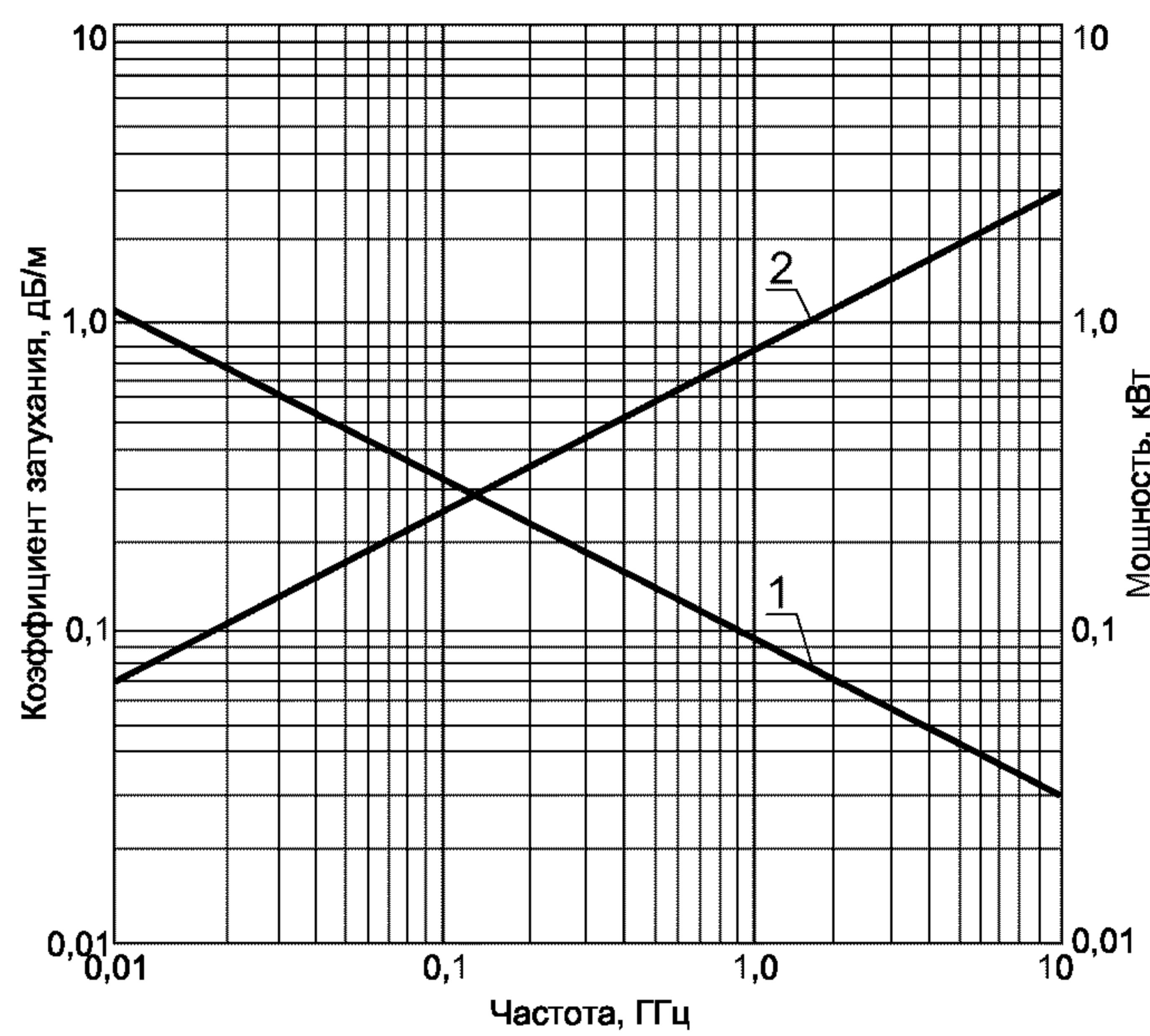
1 — допустимая мощность  $P$  на входе при температуре 40 °C
