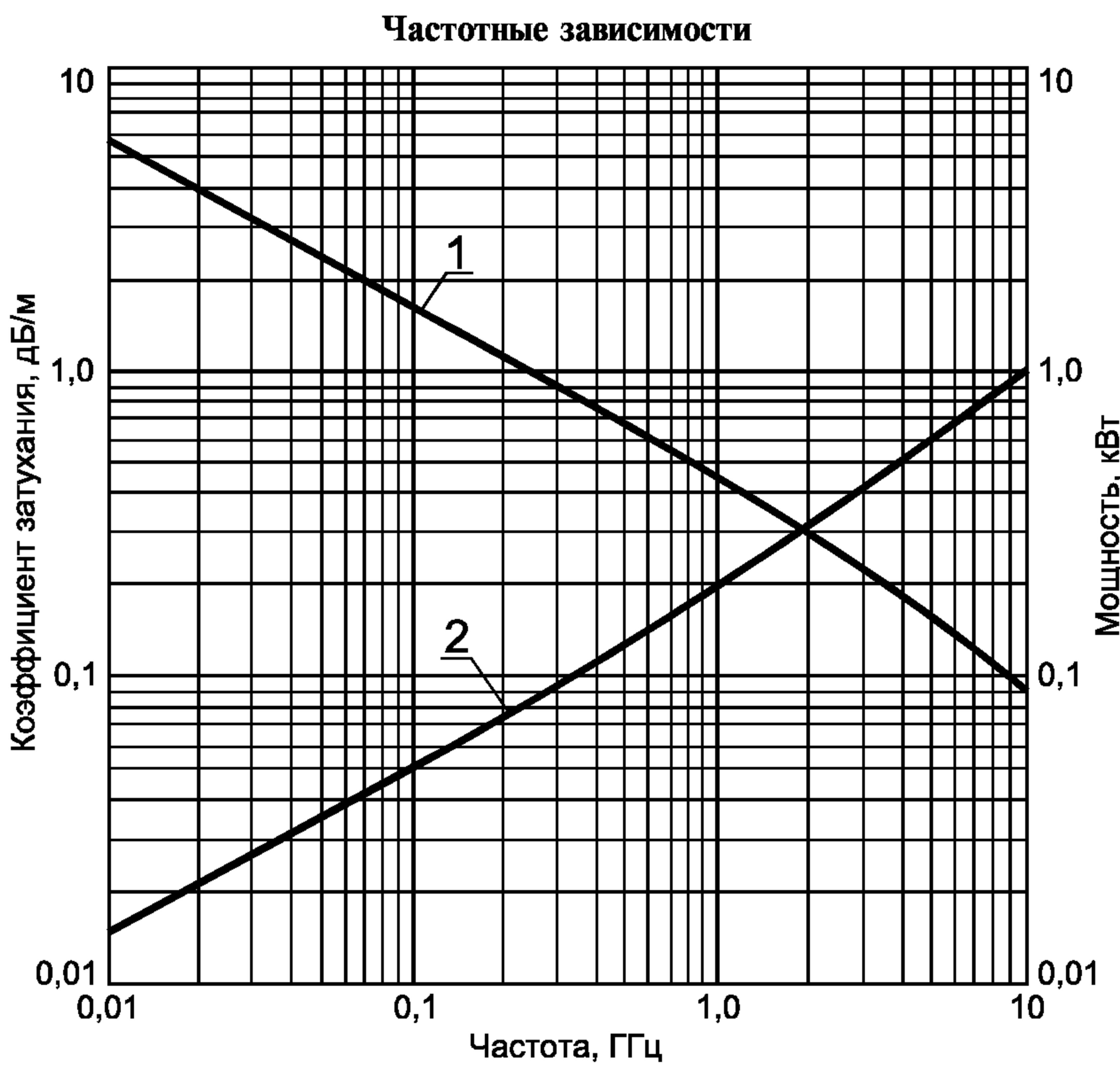
1 — допустимая мощность  $P$  на входе при температуре 40 °С и коэффициенте стоячей волны напряжения, равном 1;
