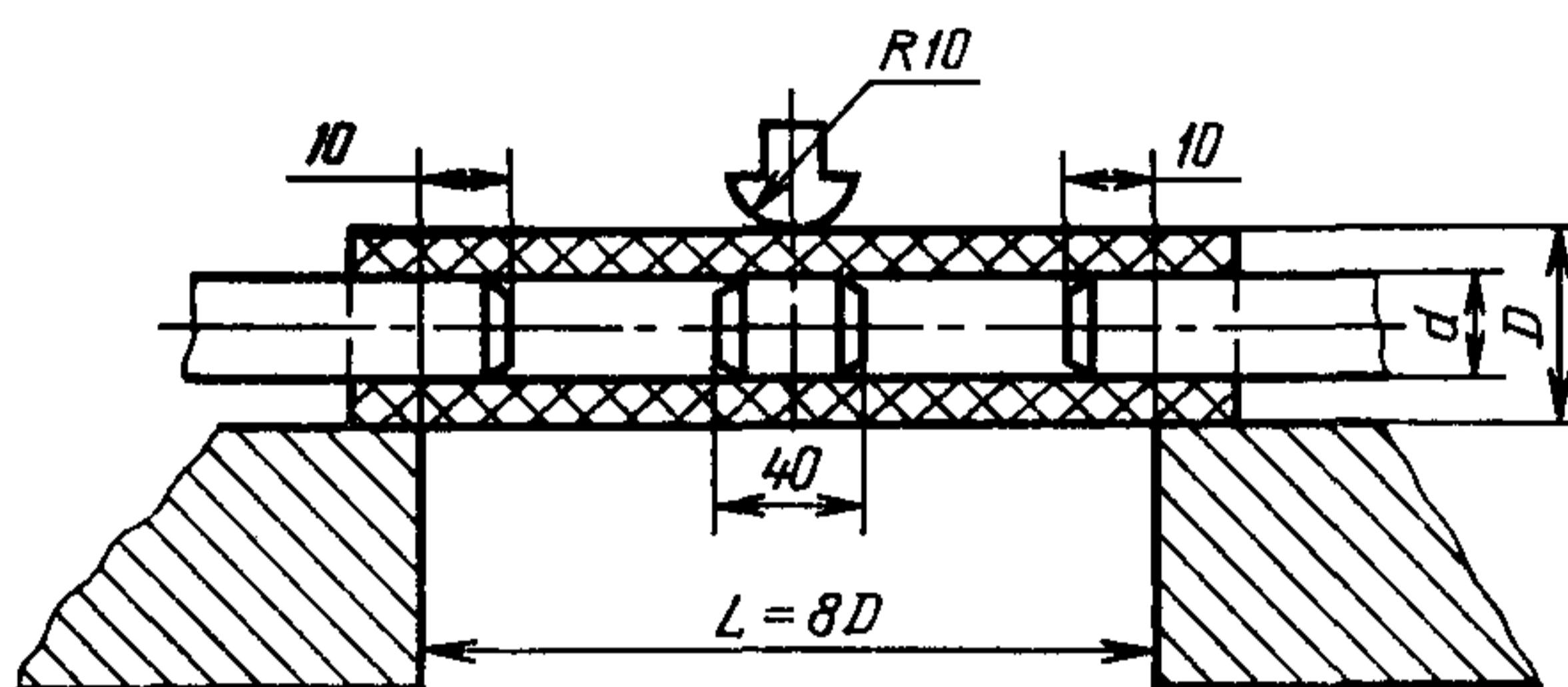
По середине и по концам образца вставляют металлические цилиндрические оправки.
