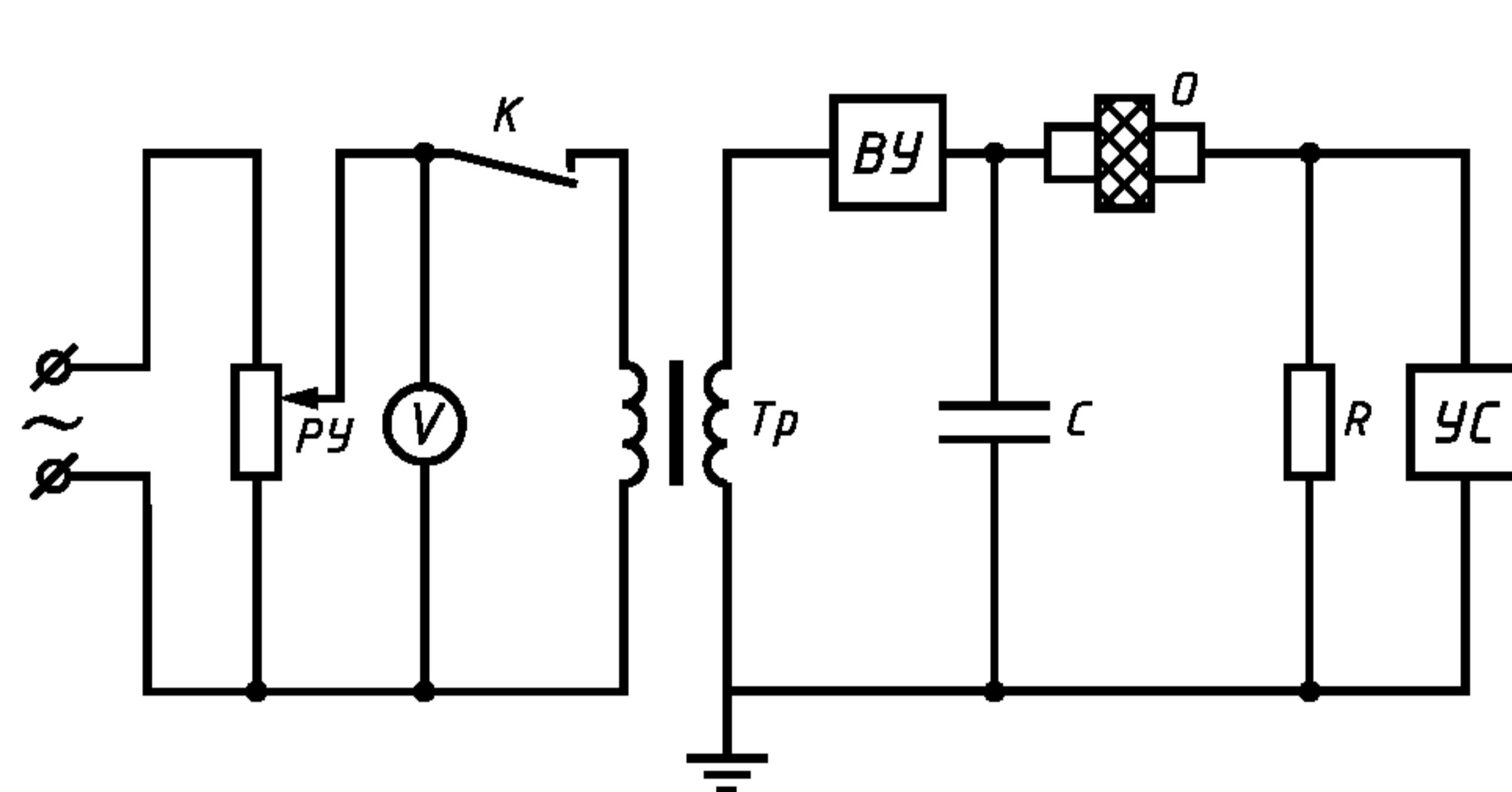
Tr — высоковольтный испытательный трансформатор; R — резистор; РУ — регулятор напряжения; О — образец с электродами; V — вольтметр для измерения напряжения пробоя; УС — устройство сигнализации о наступлении пробоя; К — контакт устройства сигнализации, отключающий первичную цепь трансформатора в момент пробоя образца
