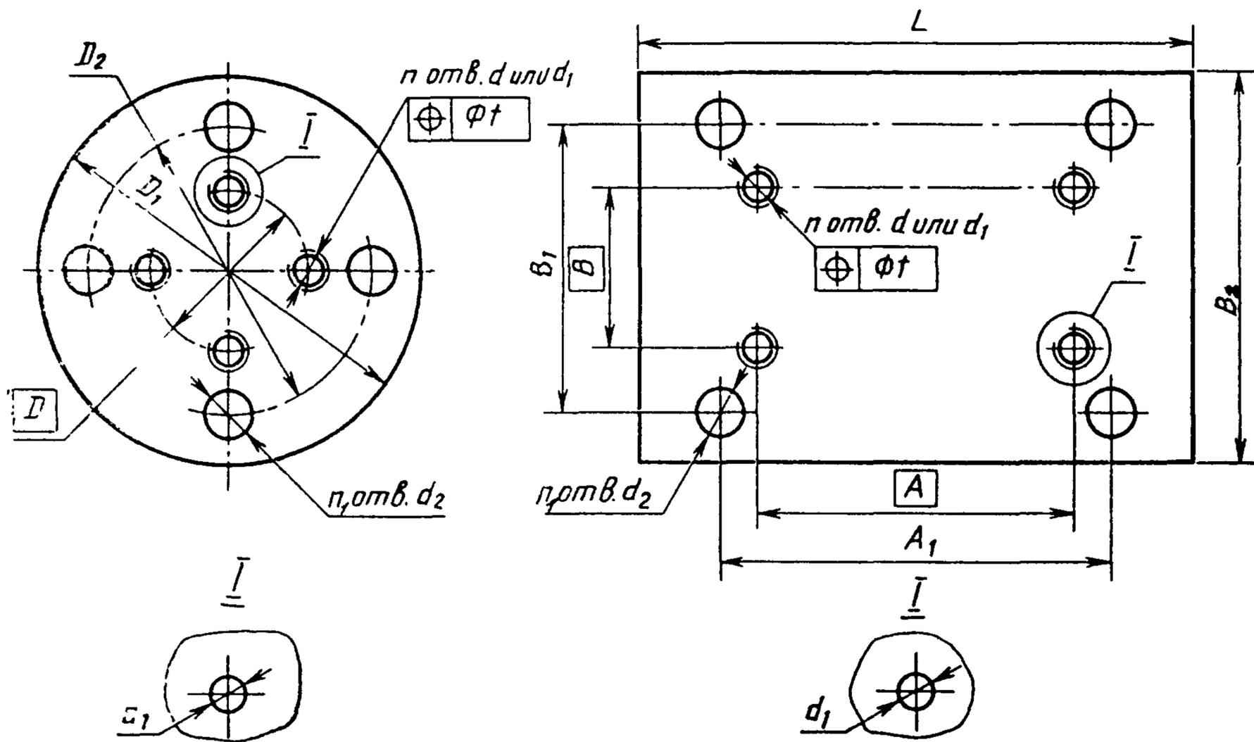
$d$  — номинальные диаметры резьбовых отверстий;  $d_1$  — номинальные диаметры крепежных отверстий;  $t$  — позиционный допуск осей крепежных отверстий
