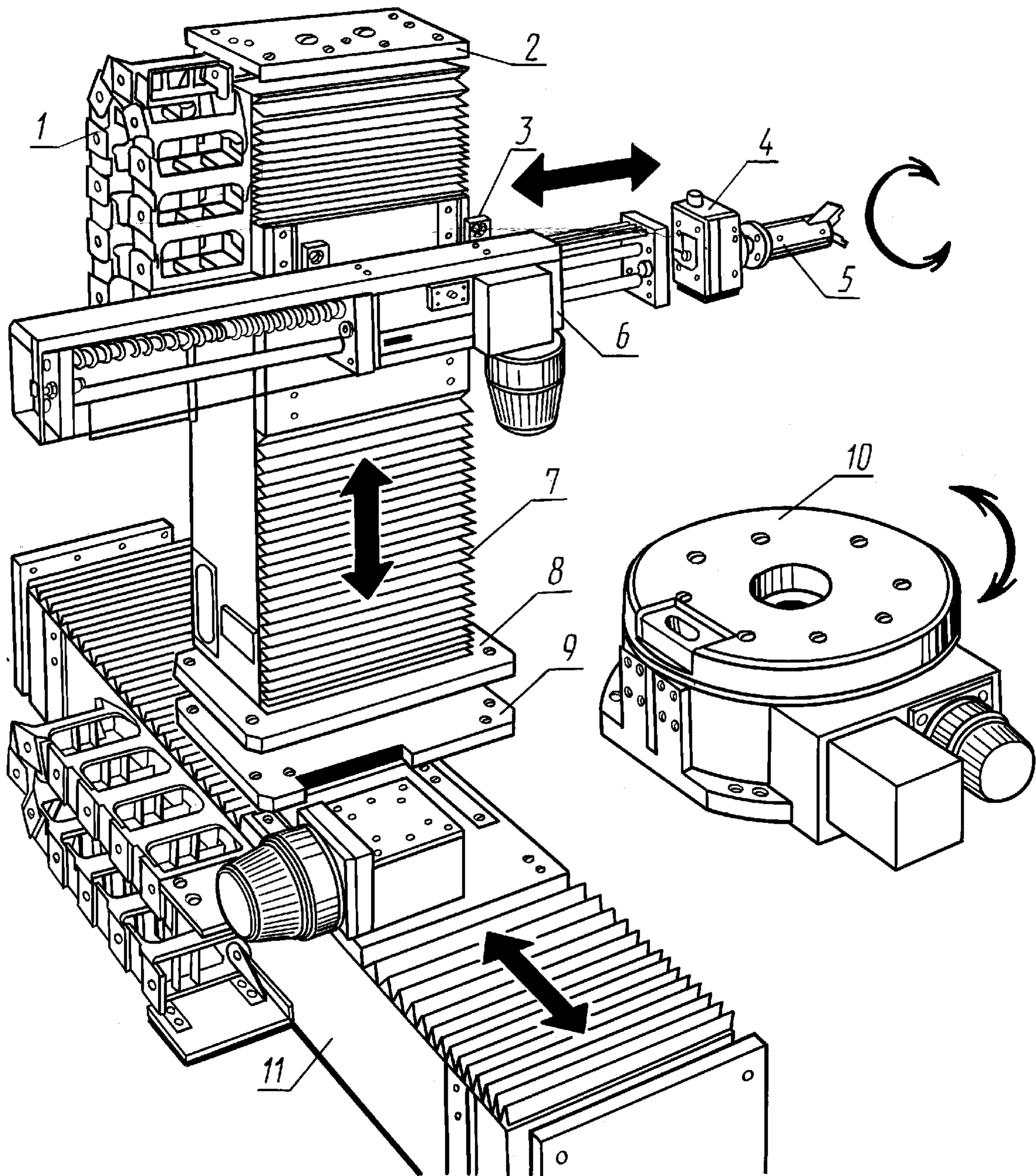
1 — цепь энергопитания (узел); 2, 8 — присоединительные фланцы (детали); 3 — крепежная планка (деталь); 4, 10 — исполнительные модули углового перемещения (выполняют функции соответственно поворота захватного устройства и поворота вокруг вертикальной оси); 5 — захватное устройство; 6, 7, 11 — исполнительные модули линейного перемещения (выполняют функции соответственно выдвижения и подъема руки и перемещения основания); 9 — переходный фланец (деталь)
