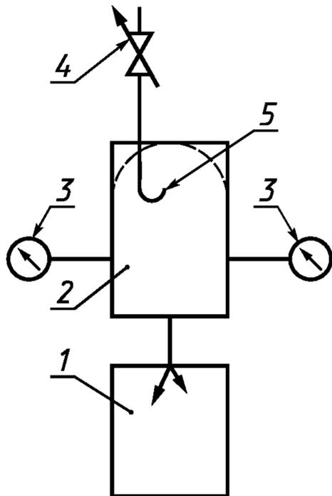
1 — испытуемый насос; 2 — измерительная камера; 3 — измерительные преобразователи давления; 4 — натекатель; 5 — напускная трубка
