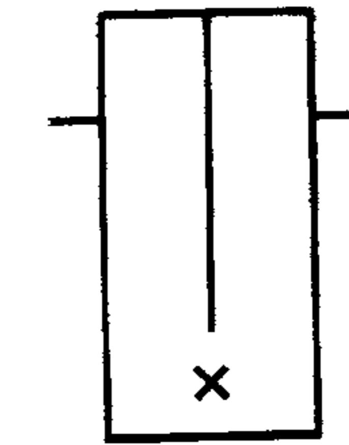
2.2 Ловушка, охлаждаемая жидкостью, заливаемой в резервуар
