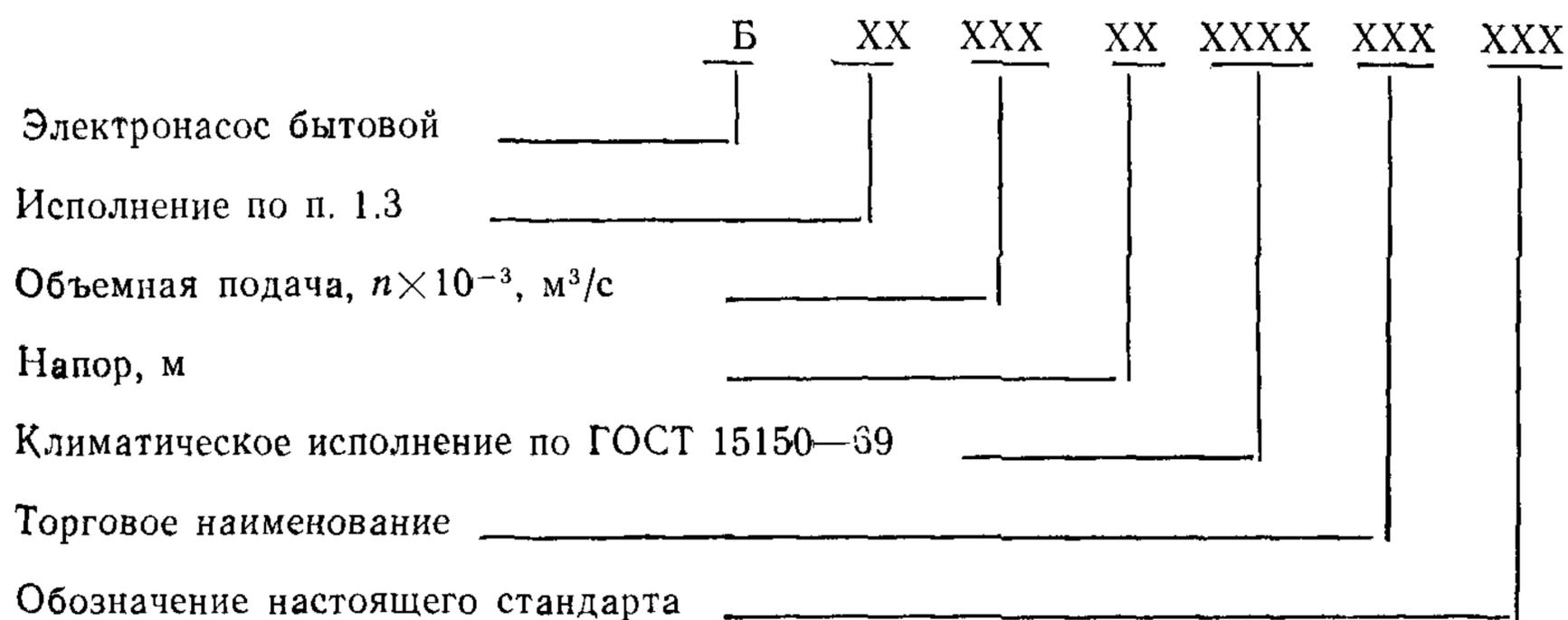
Пример условного обозначения вибрационного электронасоса с объемной подачей  $0,1 \cdot 10^{-3}$  м<sup>3</sup>/с, напором 63 м, климатического исполнения У5 по ГОСТ 15150—69, торговым наименованием «Малыш—М».
