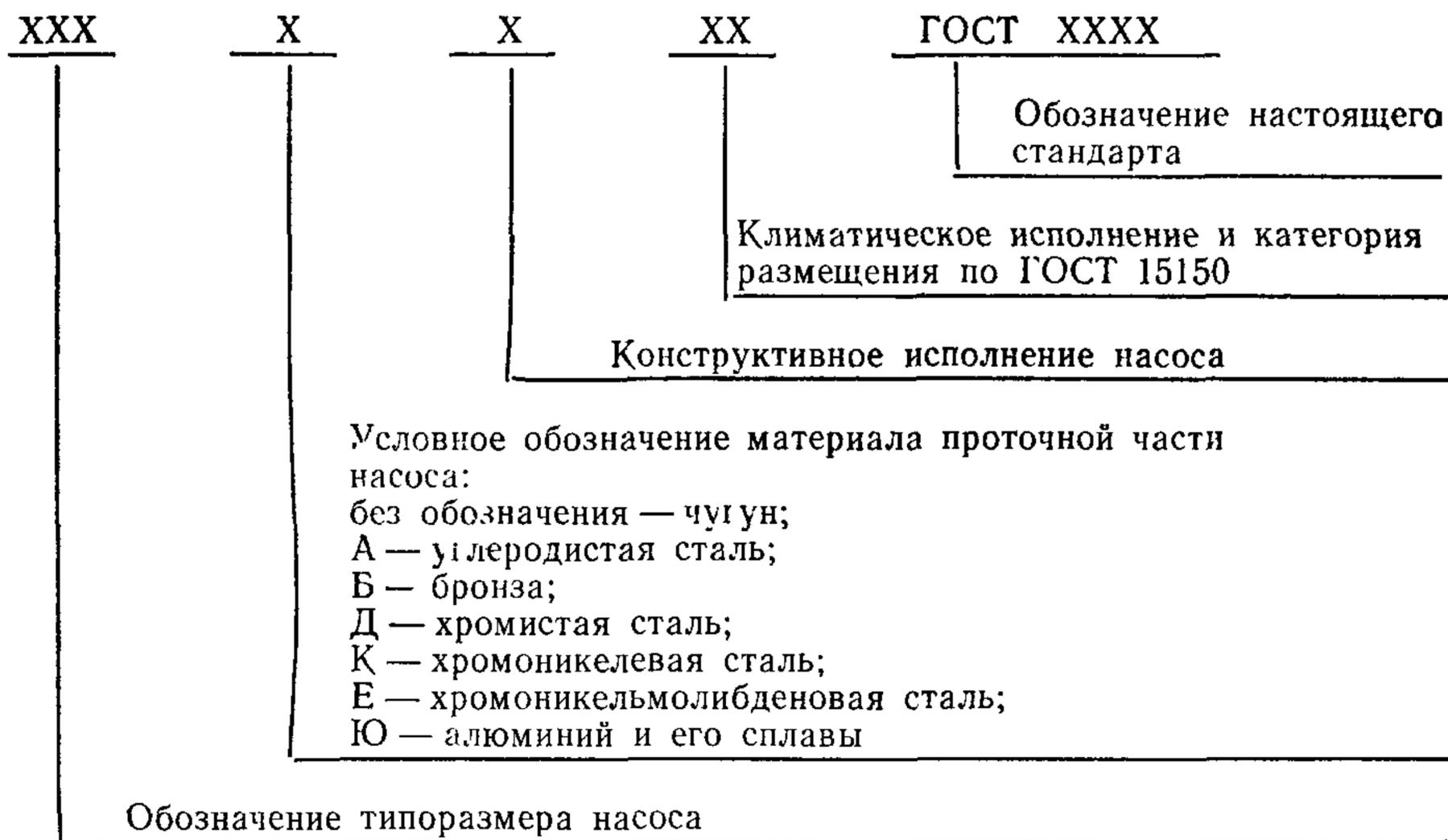
Обозначение типоразмера насоса включает в себя буквы, характеризующие исполнение в соответствии с п 1 настоящего стандарта, цифры, первая из которых указывает округленное значение подачи в литрах на 100 оборотов, а вторая — наибольшее давление насоса в мегапаскалях, увеличенное в 10 раз.
