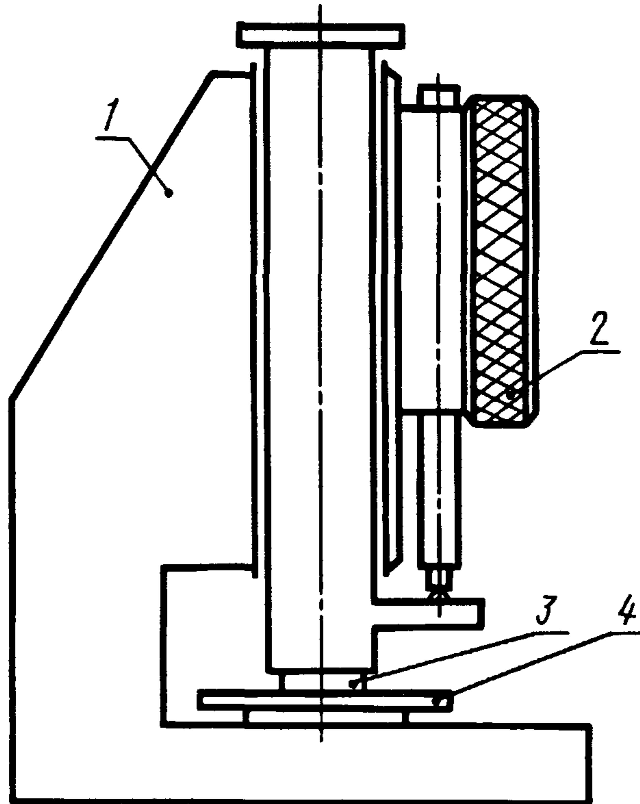
1 — корпус; 2 — индикатор часового типа; 3 — индентор; 4 — образец
