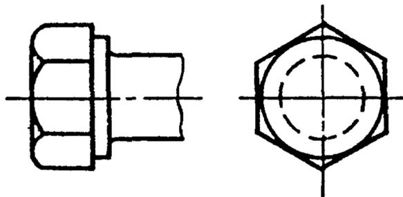
2.3. Шестигранная головка с цилиндрическим буртом
