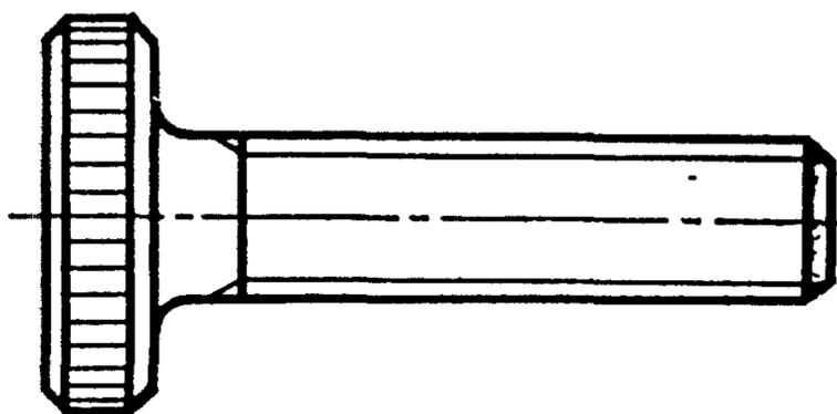
24.2. Винт с рифленой цилиндрической головкой и коническим концом
