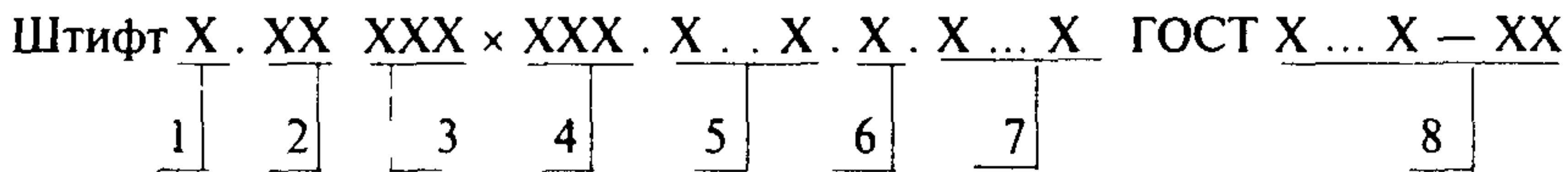
1 — исполнение. Исполнение 1 не указывается; 2 — диаметр штифта; 3 — поле допуска диаметра. Указываются только нерекомендуемые поля допусков; 4 — длина штифта; 5 — марка материала. Марка стали 45 не указывается; 6 — указание о термообработке незакаленных штифтов — буква Т; 7 — обозначение покрытия по ГОСТ 9.306. Допускается цифровое обозначение вида покрытия по ГОСТ 1759.0; 8 — обозначение стандарта на штифт конкретного вида.
