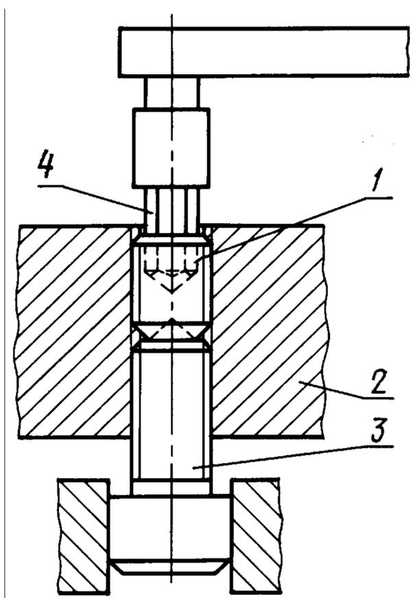
Для испытания на кручение установочный винт 1 ввинчивают в резьбовое отверстие (допуск резьбы — 5Н) контрольной плиты 2 до упора в винт 3, ввинченный с другой стороны плиты, при этом верхняя поверхность испытуемого винта должна быть утоплена в контрольной плите.
