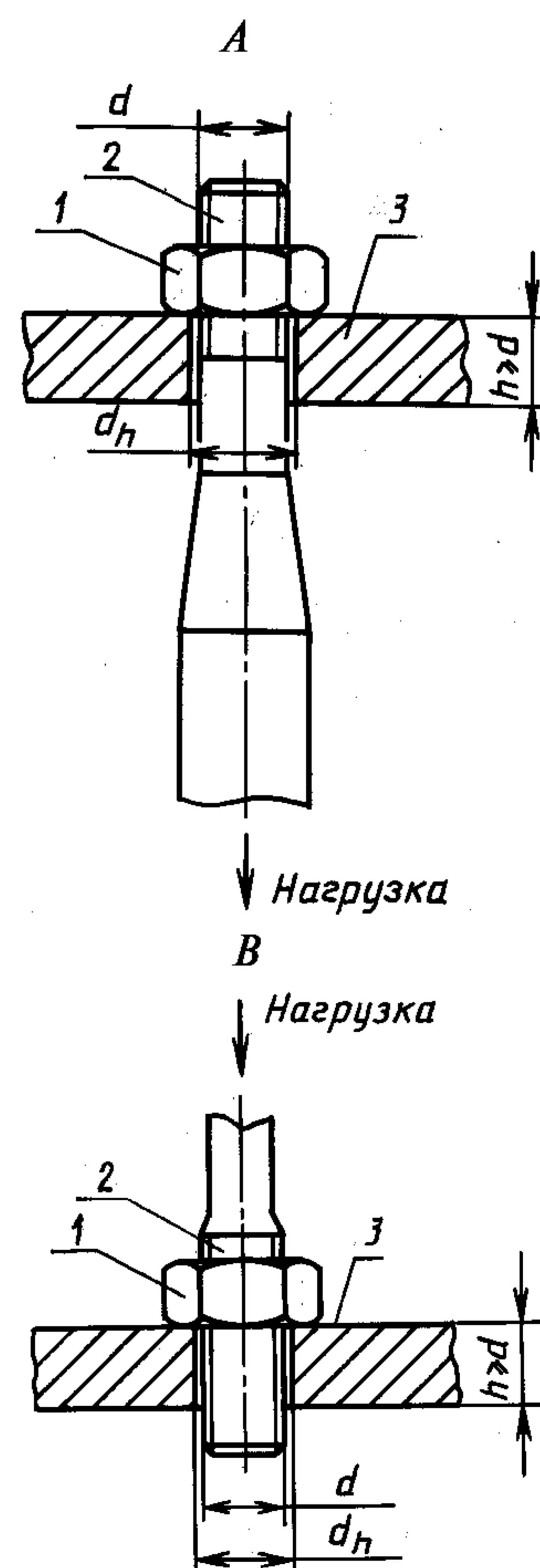
1 — гайка; 2 — испытательная оправка; 3 — закаленная пластина;
