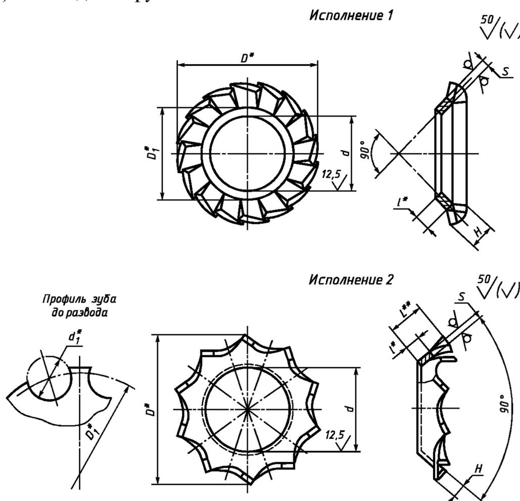
\* Размеры обеспечиваются инструментом.
