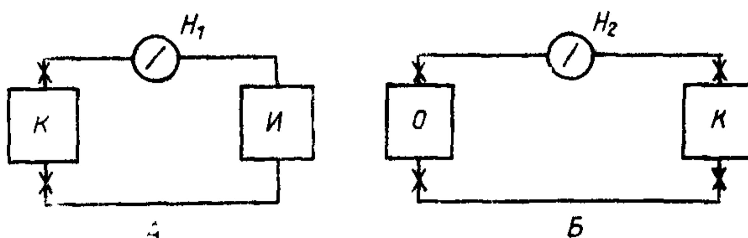
О—газовая камера образцового СИ; И—газовая камера испытуемого СИ; К—калиброванная емкость (входит в состав радиометра РГБ-07);  $H_1$ ,  $H_2$ —насосы
