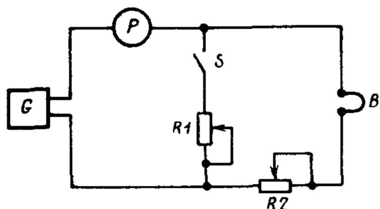
$R1, R2$  — магазины сопротивлений переменного тока класса точности 0,5;  $B$  — гальванометр;  $P$  — миллиамперметр переменного тока класса точности 1,5;  $S$  — выключатель;  $G$  — генератор переменного напряжения с коэффициентом нелинейных искажений 2%
