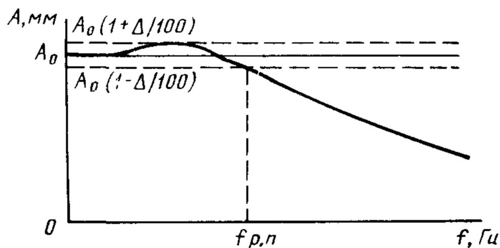
$A$  — амплитуда колебаний светового пятна при частоте  $f$ ;  $A_0$  — амплитуда колебаний светового пятна при частоте, не превышающей 5% номинального значения собственной частоты;  $\Delta$  — допуск на нелинейность амплитудно-частотной характеристики, выраженный в процентах;  $f_{р.п}$  — верхняя граница рабочей полосы частот
