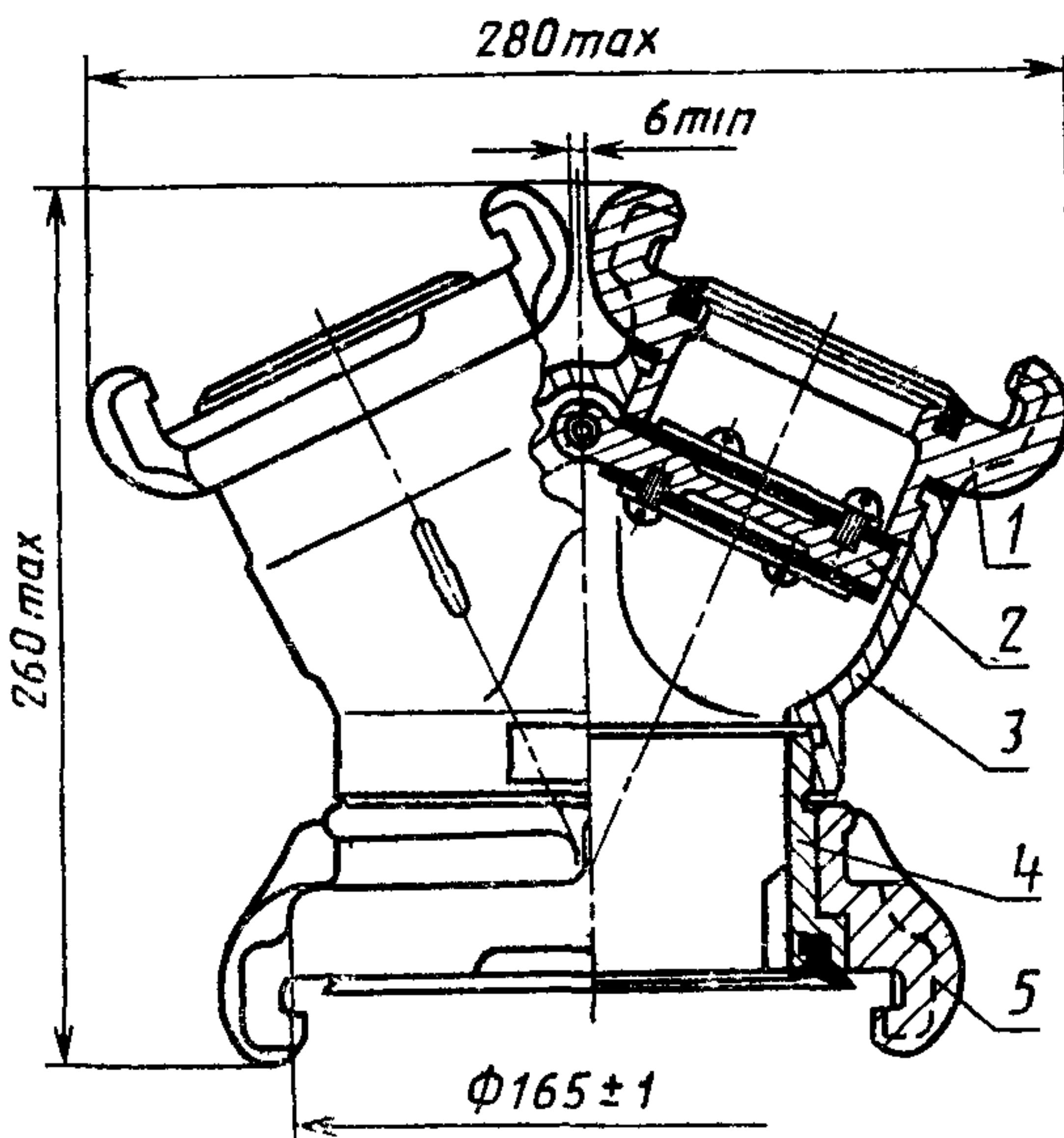
1; 5—соединительные головки; 2—клапан; 3—корпус; 4—выходной патрубок
