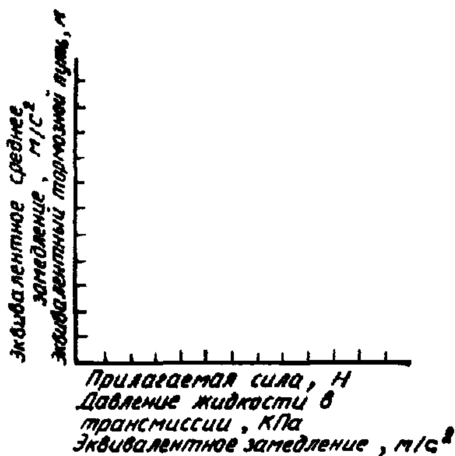
Примечание. Эквивалентное замедление определяют на основе результатов испытаний методом, основанным на измерении замедления. Давление жидкости приведено для гидравлической трансмиссии
