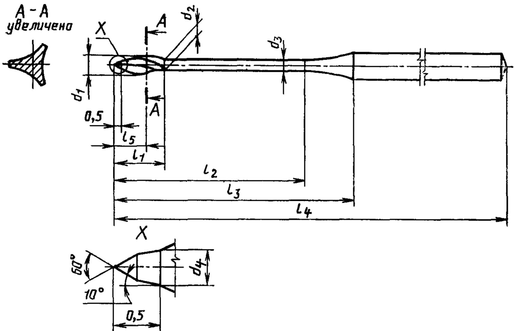
$d_1$  — диаметр рабочей части;  $d_2$  — диаметр шейки на конце рабочей части;  $d_3$  — диаметр шейки на конце оперативной части;  $d_4$  — начальный диаметр направляющего конуса рабочей части;  $l_1$  — длина рабочей части;  $l_2$  — длина оперативной части;  $l_3$  — длина оперативной части с шейкой;  $l_4$  — общая длина;  $l_5$  — расстояние от направляющего конуса рабочей части до сечения А—А (при максимальном диаметре  $d_1$ )
