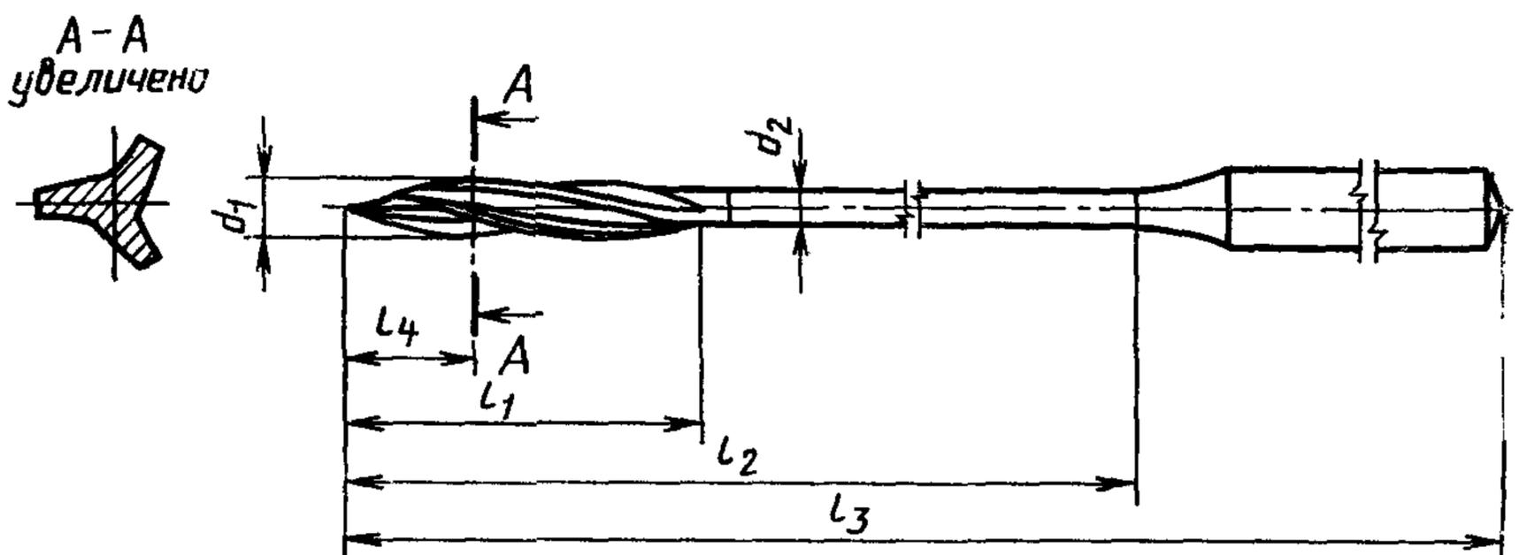
$d_1$  — диаметр рабочей части;  $d_2$  — диаметр шейки;  $l_1$  — длина рабочей части;  $l_2$  — длина оперативной части;  $l_3$  — общая длина;  $l_4$  — расстояние от направляющего конуса рабочей части до сечения А-А (при максимальном диаметре  $d_1$ )
