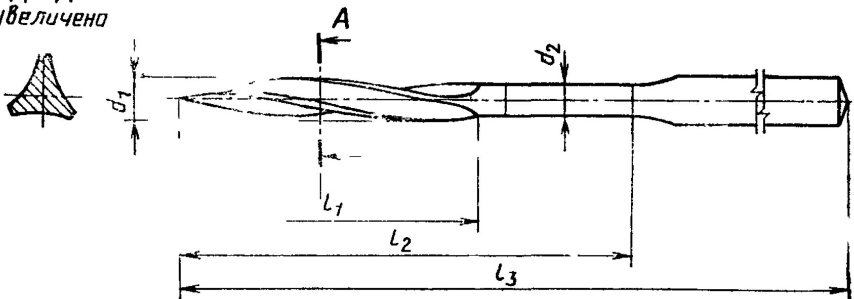
$d_1$  — диаметр рабочей части;  $d_2$  — диаметр шейки;  $l_1$  — длина рабочей части;  $l_2$  — длина оперативной части;  $l_3$  — общая длина;  $l_4$  — расстояние от направляющего конуса рабочей части до сечения А-А (при максимальном диаметре  $d_1$ )
