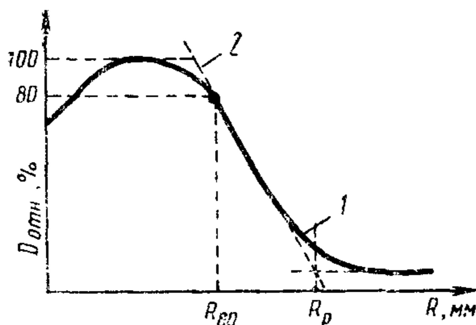
$D_{\text{отн}}$  — относительная поглощенная доза или относительный ионизационный ток;  $R$  — глубина в водном фантоме; 1 — кривая осевой относительной глубинной дозы или ионизации; 2 — касательная в точке перегиба.
