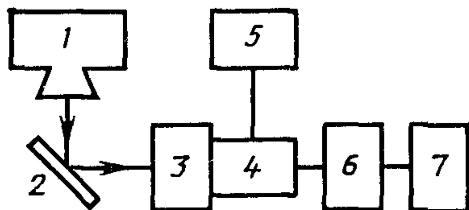
1 — источник излучения (рентгеновский аппарат); 2 — экран; 3 — монохроматор; 4 — фотоэлектронный умножитель (ФЭУ); 5 — блок питания к ФЭУ; 6 — усилитель; 7 — самопишащий регистрирующий прибор
