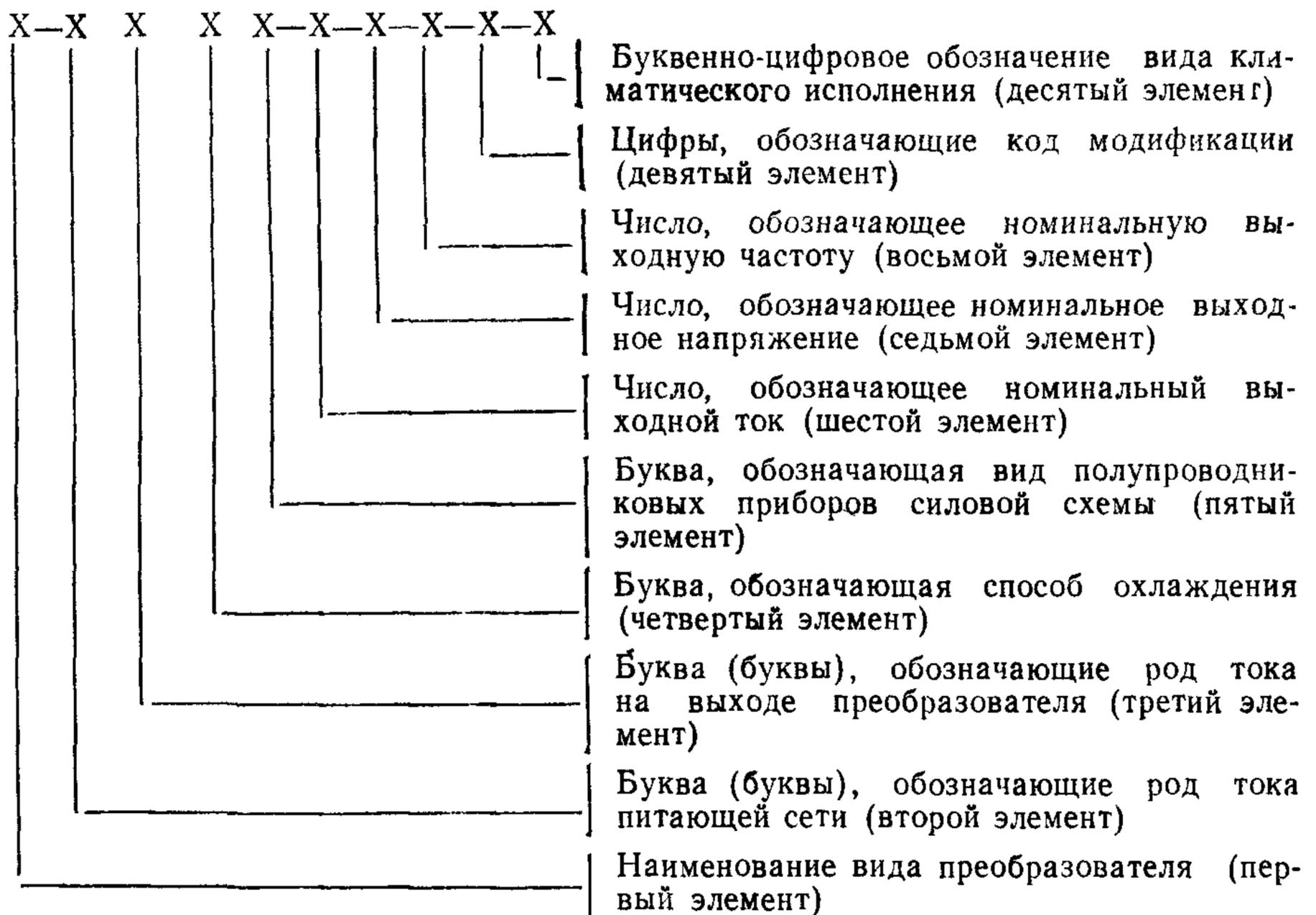
7. Пример записи условного обозначения трехфазного тиристорного неперсивного выпрямителя с принудительным воздушным охлаждением, с номинальным значением выпрямленного тока 315 А, номинальным напряжением 230 В, климатического исполнения и категории размещения УХЛ4, первой конструктивной модификации (например с фильтром):
