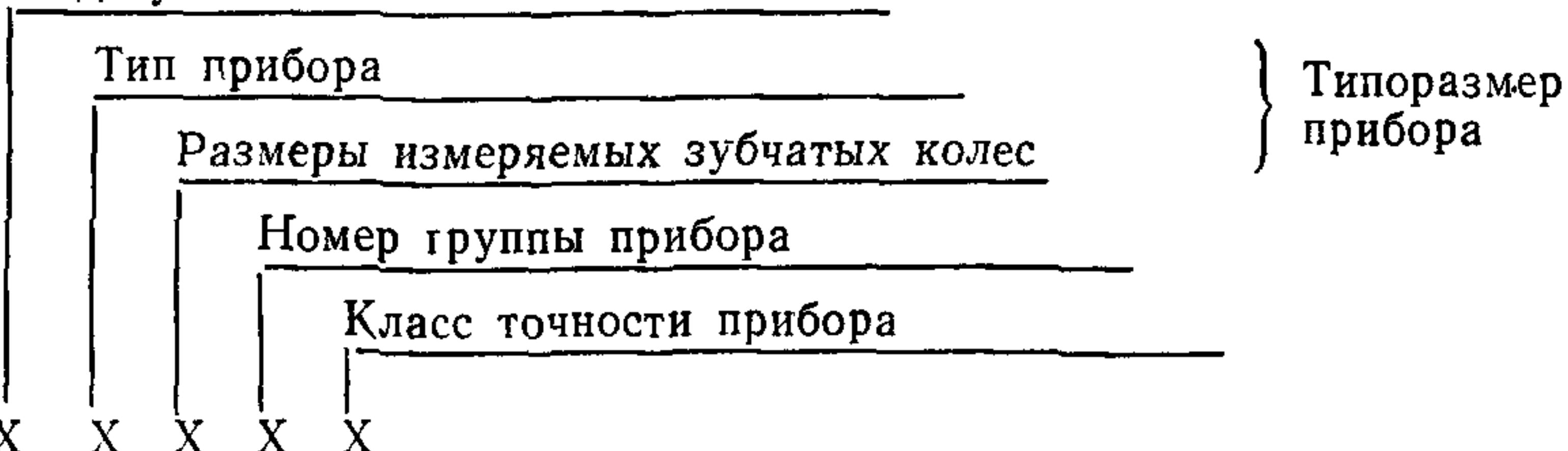
1.3. Пример условного обозначения прибора для измерения цилиндрических зубчатых колес, станкового, для зубчатых колес с модулем  $m \geq 1$  мм, для измерения кинематической погрешности, класса точности А:
