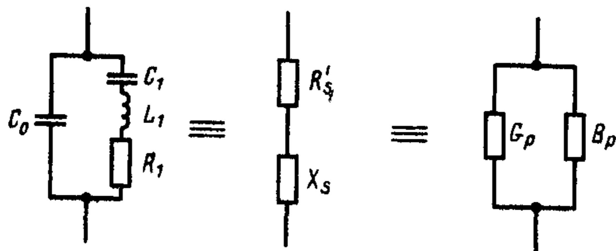
$R'_s$  — эквивалентное последовательное сопротивление пьезоэлектрического резонатора;
