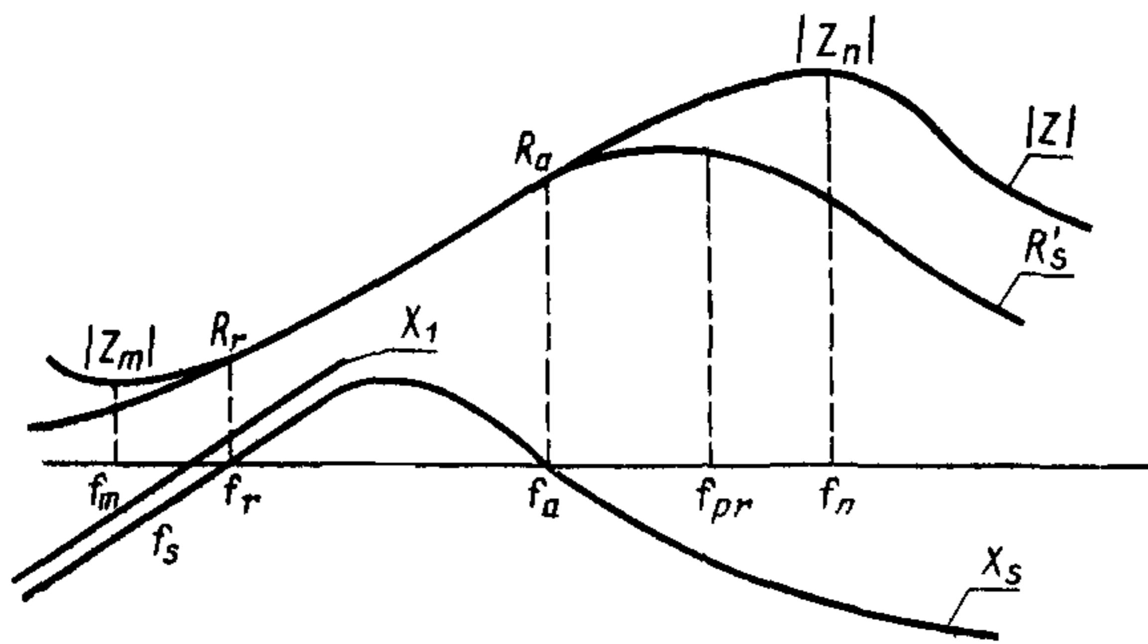
$Z$  — полное сопротивление пьезоэлектрического резонатора, определяемое по формуле  $Z = R'_S + jX_s$ ;
