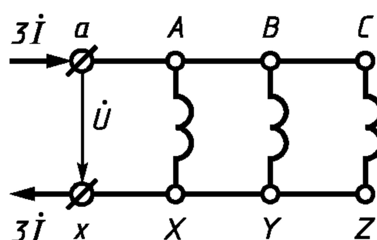
**К. п. 115. Сопротивление сдвоенного реактора****Однофазный реактор**
