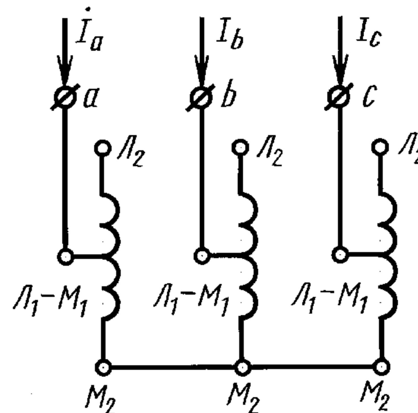
**К. п. 117. Сквозное сопротивление сдвоенного реактора**
