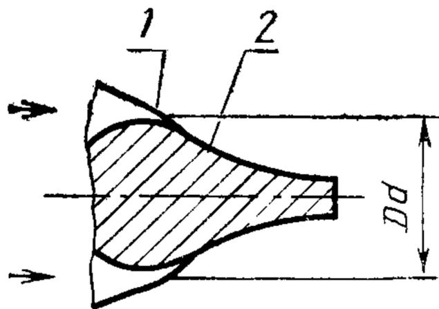
1 — внешний участок контура 2 — внутренний участок контура
