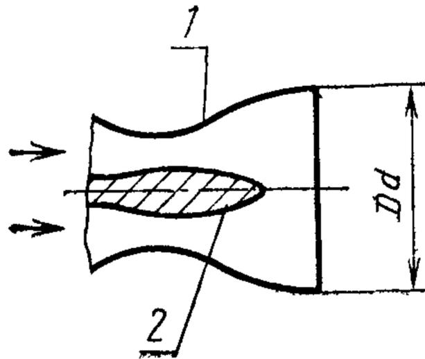
1 — внешний участок контура, 2 — внутренний участок контура
