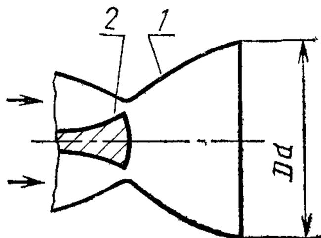
1 — внешний участок контура. 2 — внутренний участок контура
