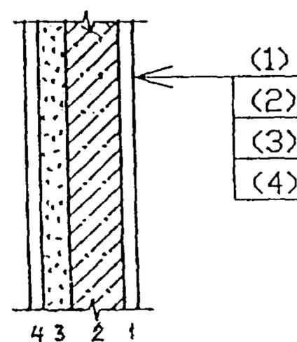
ПРИМЕЧАНИЕ - ЦИФРАМИ УСЛОВНО ОБОЗНАЧЕНА ПОСЛЕДОВАТЕЛЬНОСТЬ РАСПОЛОЖЕНИЯ СЛОЕВ КОНСТРУКЦИИ И НАДПИСЕЙ НА ПОЛКАХ ЛИНИЙ-ВЫНОСОК
