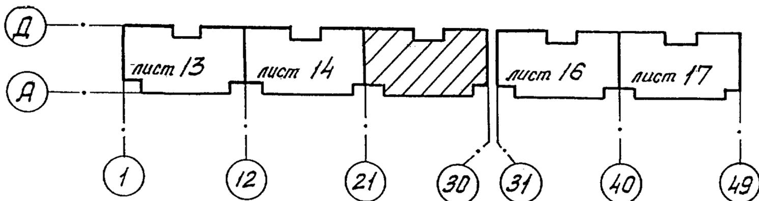
Примечание - Если чертежи участков помещены в разных основных комплектах рабочих чертежей, то над номером листа указывают обозначение соответствующего основного комплекта
