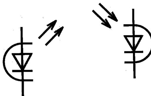
2. Взаимная ориентация обозначений источника и приемника не устанавливается, а определяется удобством вычерчивания схемы, например:
